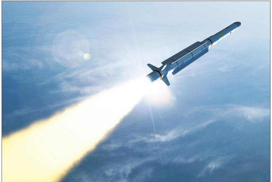
*CAMM-ER von MBDA UK Ltd ist Teil einer Familie (CAMM: common anti-air modular missile extended range) von Flugabwehr-Lenkflugkörpern der nächsten Generation, die für den Einsatz von Land, von See und in der Luft entwickelt wurden. (Bild und Text MBDA Präsentation anlässlich AVIA-Symposium vom 28. März 2015 in Dübendorf)*
