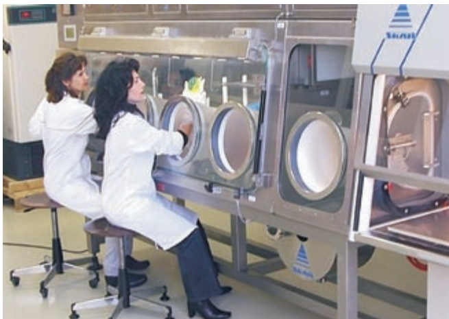
Heute verfügt das Labor Spiez über eine kleine, geschlossene Biologielaboreinheit der Sicherheitsstufe 3 in einer so genannten Glove-Box, aber leider über noch kein Biologielabor der höchsten Sicherheitsstufe 4. Für die Schweiz noch Zukunftsmusik - bis das Sicherheitslabor VBS in einigen Jahren in Betrieb genommen wird. (Foto: Labor Spiez)
